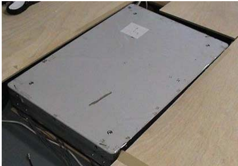
図8 実験取り付け時の床反力計測装置
