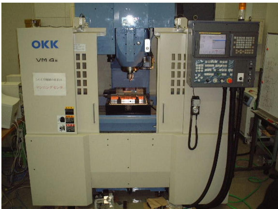
(写真 2.1) オープン CNC マシニングセンタの概観
