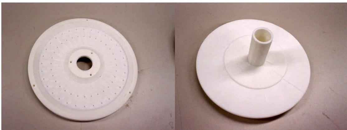
図.3-16 Rapid Prototyping で試作した発電機部品
