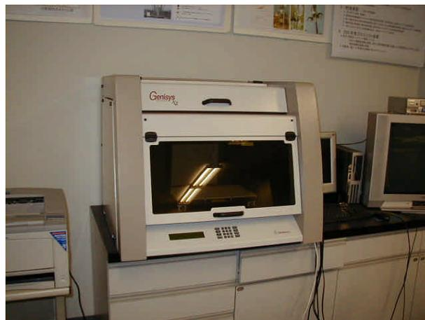
図.3-15 Rapid Prototyping 装置 Genisys XS
