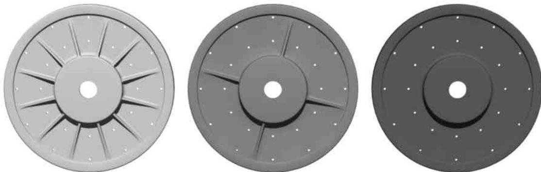
図.4-11 ハウジングモデル (左: リブ12本 中央: リブ4本 右: リブなし)
