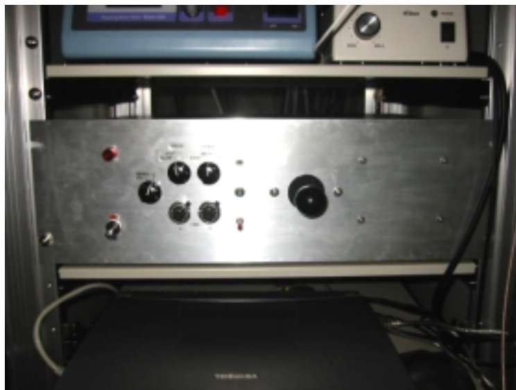
図 6.1.2 ガルバノミラー制御装置(外観)
