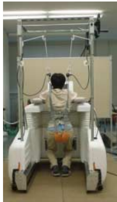
図 5.5 転倒防止実験
