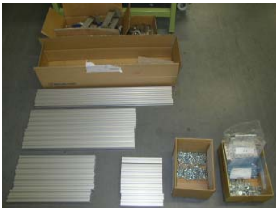
Fig4-2-6 フレーム及び組み立て部材
