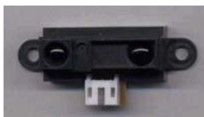
Fig3-2-6 PSD 素子距離センサ GP2D12(株Sharp 製)
