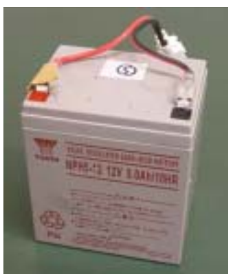
Fig3-2-8 12v 小型シール鉛蓄電池 NPH5-12
