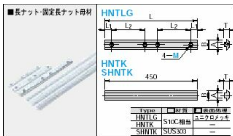
Fig4-2-5 長ナット (HNTLG M6)
