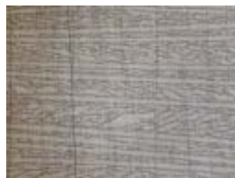
図 2.28 デフォーカス値 3 mm 微細マルテンサイト +残留オーステナイト
