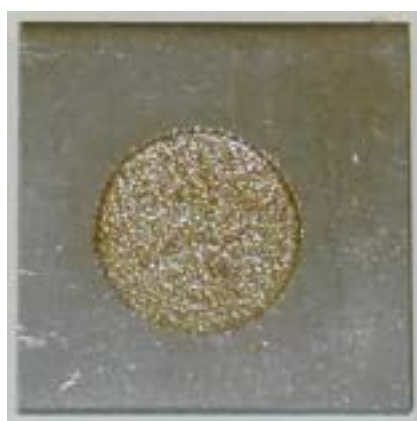
図 3.1 形彫放電加工による 荒加工面( 80 \mu\text{m Ry} )
