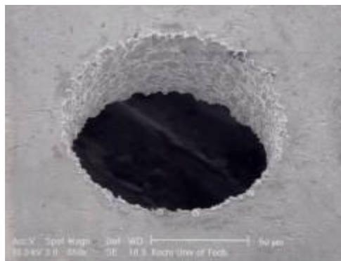
図 48 Ni 純水 3300pF 電極、加工穴
