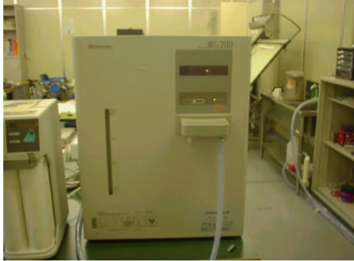
図 2.4(b) 純水製造装置 RQ500
