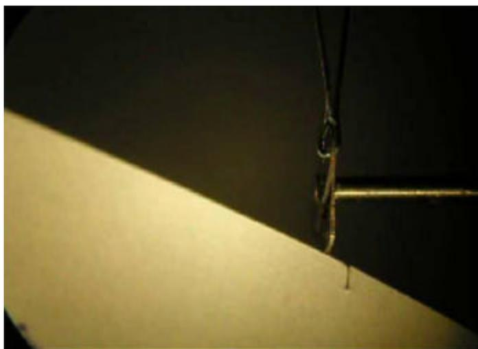
図 54 マイクロはさみによる洋紙切断連続写真 2
