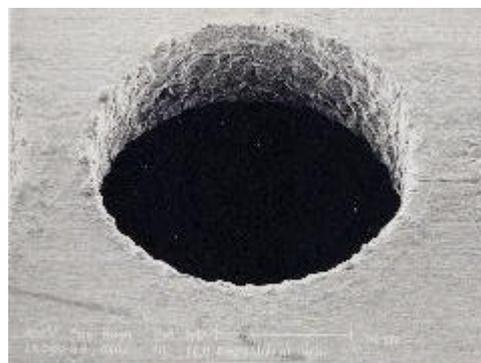
図8 純Ti 放電加工油 C=3300pF 電極と加工穴
