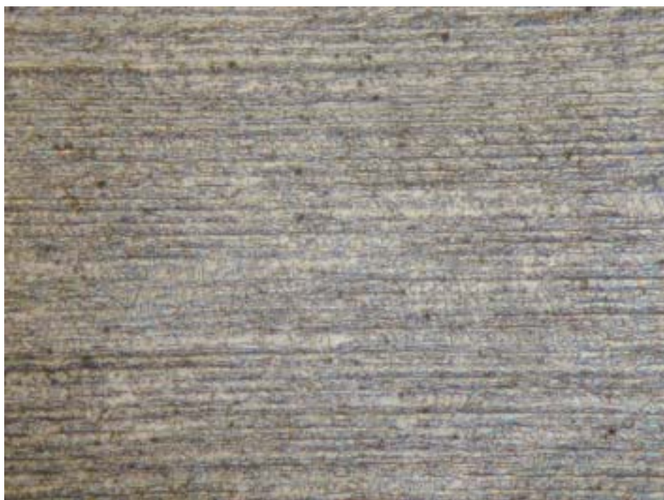
図 2-60 放電荒加工面 25\ \mu\text{m/Ry} を超高速回転ミーリングで切り込み量 45\ \mu\text{m} 加工した顕微鏡写真
