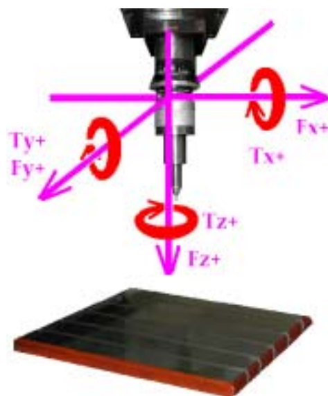
図 2-11 Force/Torque センサ定義
