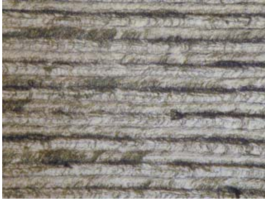
図 2-102 放電荒加工面 15\ \mu\text{m/Ry} を超高速回転ミーリングでピック量 50\ \mu\text{m} 加工した顕微鏡写真( \times 100 )
