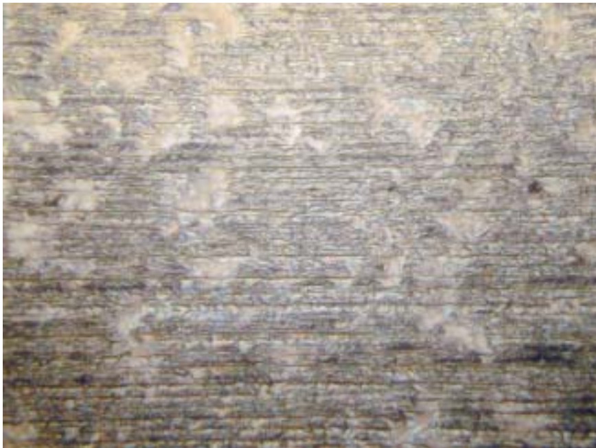
図 2-58 放電荒加工面 25\ \mu\text{m/Ry} を超高速回転ミーリングで切り込み量 35\ \mu\text{m} 加工した顕微鏡写真
