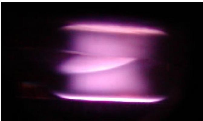
直流 7.8W ( 電圧 : 123V、電流 : 64mA )
