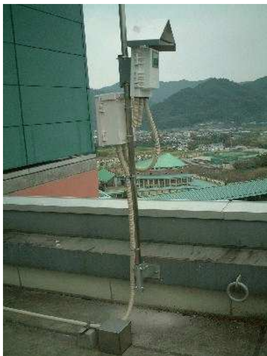
図 2.3 定点観測システム (景観カメラ部分)
