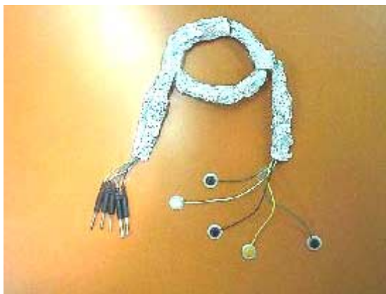
(a) 湿式電極(基礎システム)
