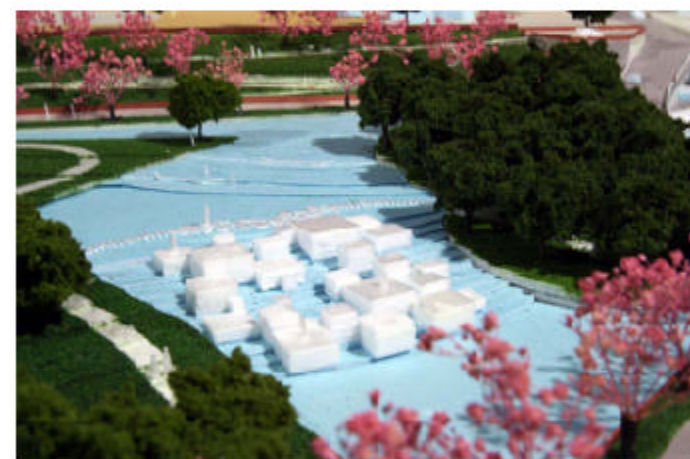
・親水空間（中井川～舟入川） 15cm程度の水深と1:6の傾斜に高さ2m以下の様々な大きさの立方体のモニュメントを設置する。
