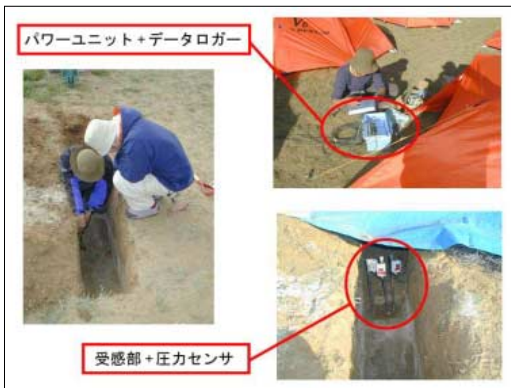
図 2.11 テンシオメータと土壌水分吸引力観測風景
