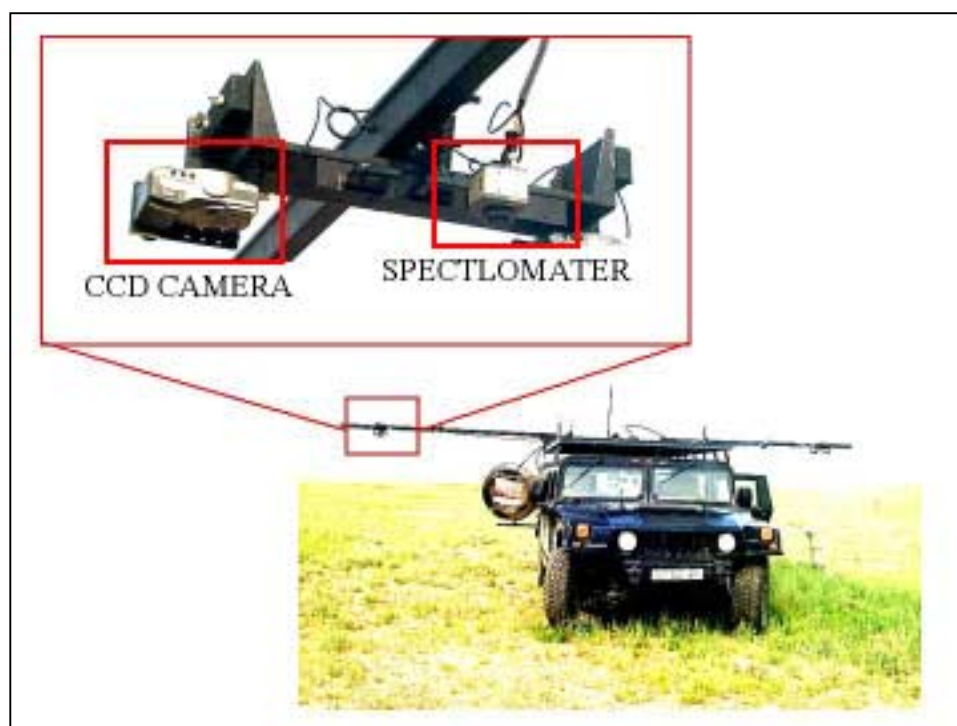
図 2.16 千葉大学観測車と搭載されている観測機器
