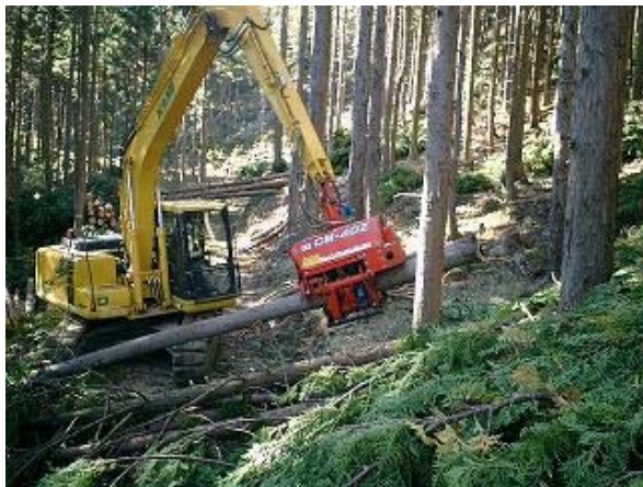
写真1 機械化林業による間伐作業（左）、残材（右）
