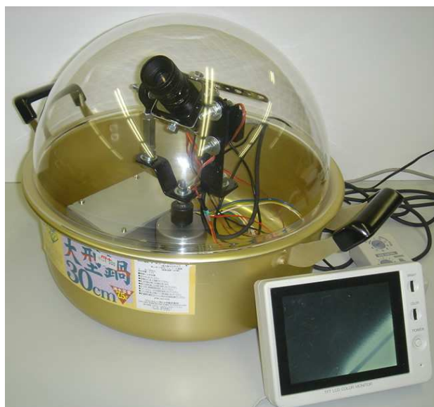
図 2.13 製作したケース(右下の液晶モニタは確認用)
