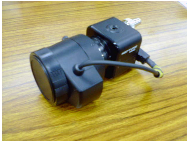
図 2-7 観測用カメラ(Watec 社 Neptune-100N 及び CBC 製 8mm, f/0.8 レンズ)
