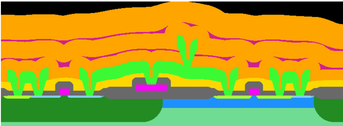
図 3-2 インバータ回路(図 3-1)断面構造シミュレーション
