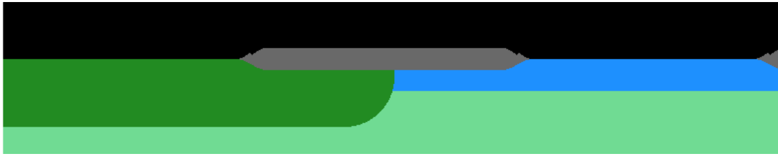
図 4-4f 素子分離(フィールド酸化膜形成)
