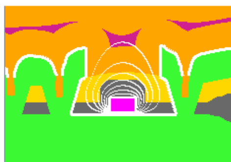
図 3-10 電位分布算出結果(5V)
