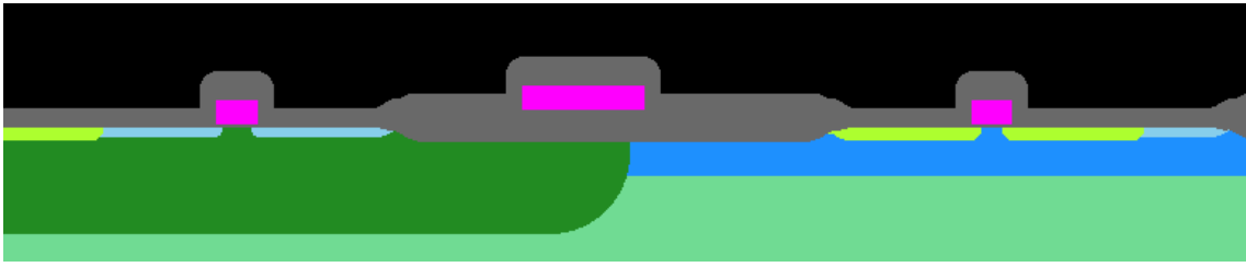
図 4-9 非ダマシン構造 素子形成
