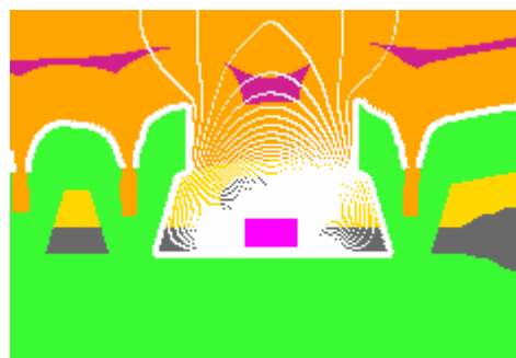
図 3-12 電位分布結果(5V 0.1V 刻み)
