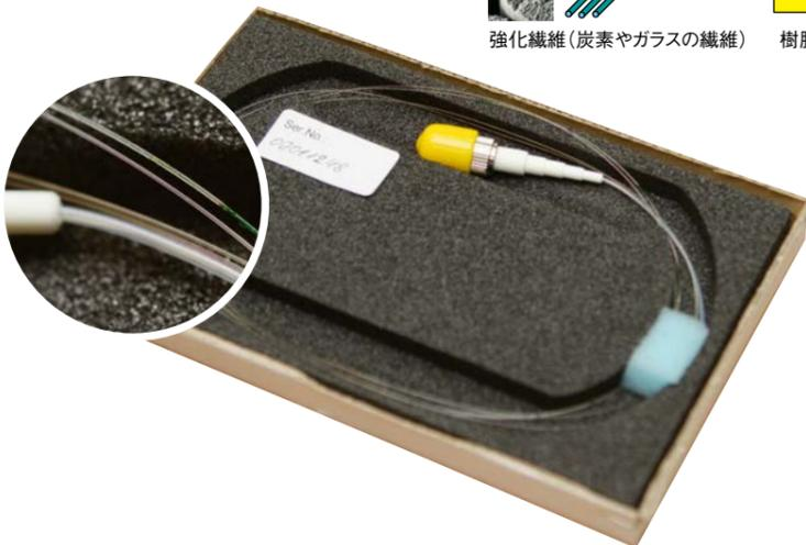
航空機の健全性モニタリングでは、直径0.1mmという極細の光ファイバーセンサを翼に入れ、飛んでいる間も監視する。最終的には、翼だけでなく、機体全体に入れることが目標だという。
