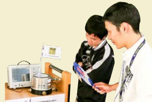
インフラサウンドを観測する装置。ウチワでゆっくりと仰いだ矮小な風の音も検知できる。
