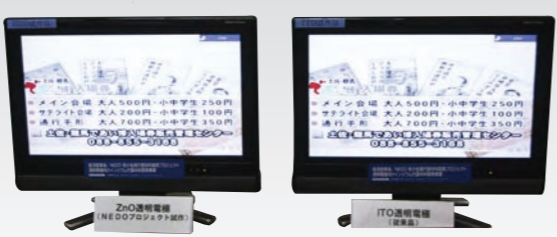
電極をむら無く大面積で製作する新技術。1メートル四方のZnO透明導電膜は世界初です。
