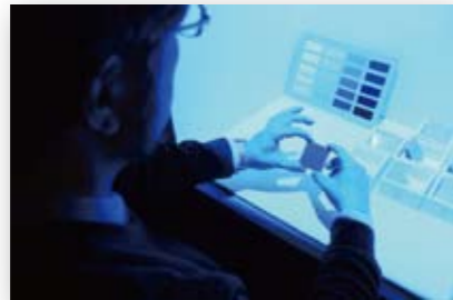
JIS標準色票(写真下)を使用し、照明光の色や照度の違いで、色の見え方などどう変わるのかを実験する。
