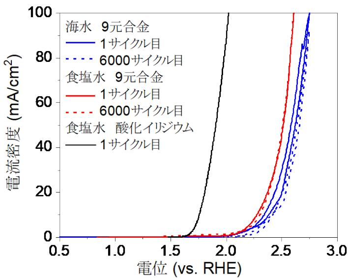
図2 水電解装置における電源のON/OFFを模擬した電流電位における加速劣化試験。
