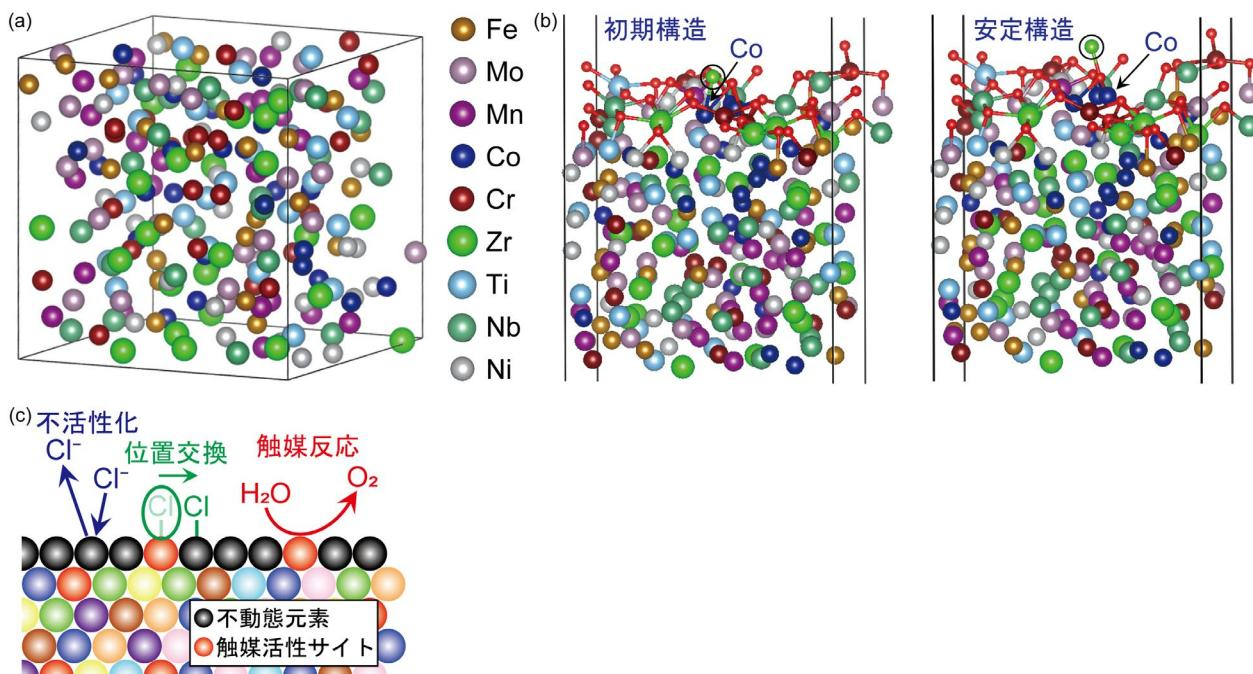
図3 9元合金構造モデルと反応シミュレーション結果。
