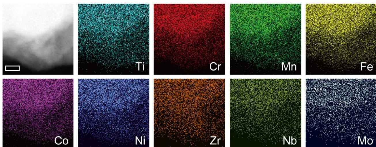
図1 9元合金の透過型電子顕微鏡像とその場元素マッピング。
