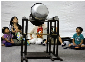
直径約30cmの調理用ボウルで制作した投影機
