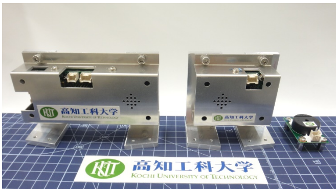
観測ロケット先端部に搭載するインフラサウンド計測機器 左から、メインマイク、サブマイク、ブザー
