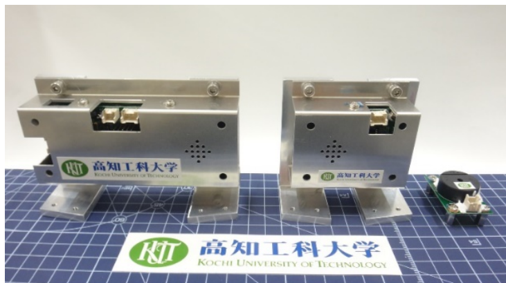
搭載するインフラサウンド計測機器 左から、メインマイク、サブマイク、ブザー
