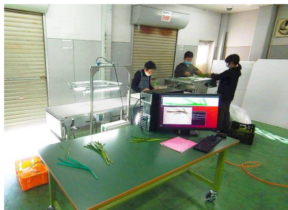
ニラ出荷支援ロボット： 収穫後のニラを①運搬②そぐり(不要な外葉等を取り除く作業)③画像認識④不良品選別するロボットのこと ※有限会社サット・システムズ、株式会社土佐ひかり CDMの3者連携により開発
