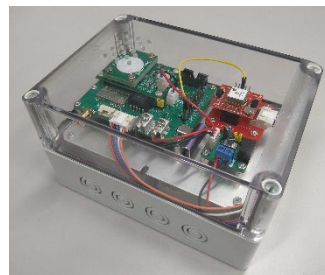
(氷震から発生するインフラサウンドを観測する記録装置)
