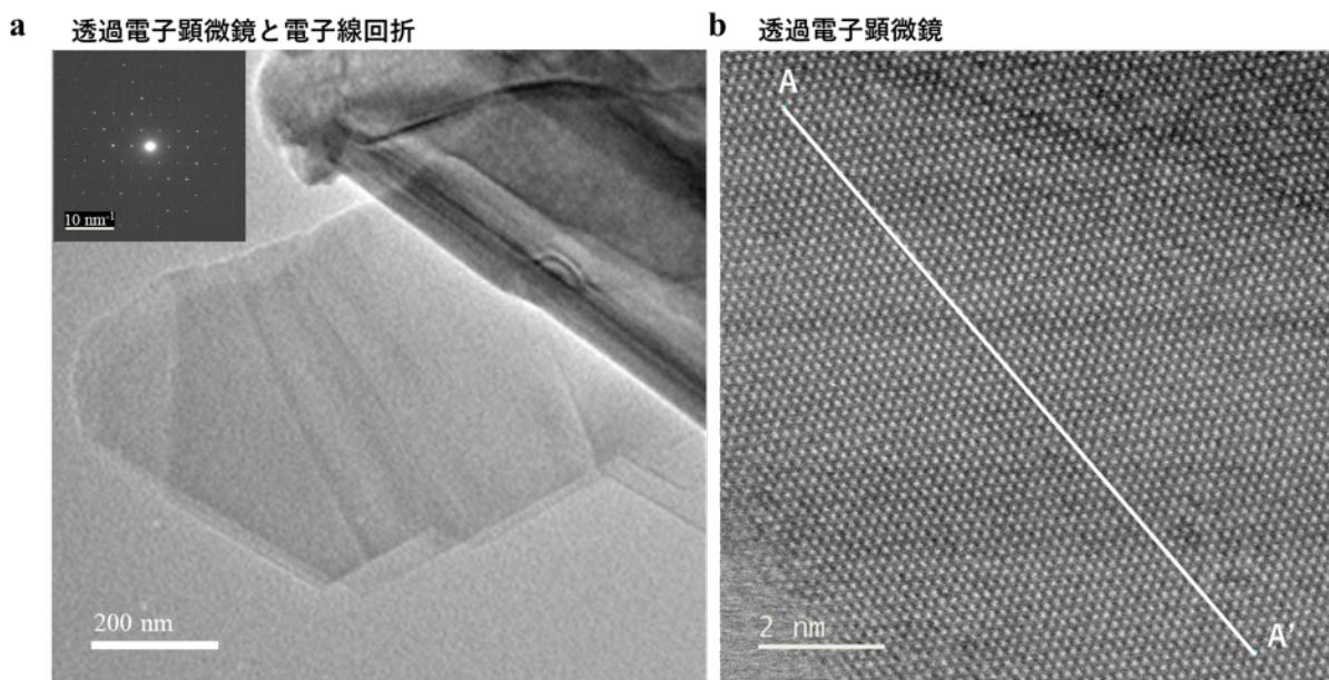
図2 (a) 菱面体硫化ホウ素の透過電子顕微鏡像。試料から剥離されたシートが中央に見られる。(b) 硫化ホウ素シートの透過電子顕微鏡像。A-A'の間には 57 個の輝点が観察され、それぞれの輝点間隔の 0.18 nm (ナノメートル) が並んでいる原子の間隔 (図3 a の赤矢印の距離) に対応する。
