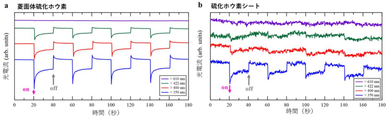
図 5 (a) 菱面体硫化ホウ素および (b) 硫化ホウ素シートの光照射による電気化学的光電流応答の照射光波長依存性 (20 秒ごとに光の On と Off を切り替えた際の電流の変化)。紫 : 610 nm 以上の波長の光照射、緑 : 422 nm 以上の波長の光照射、赤 : 400 nm 以上の波長の光照射、青 : 350 nm 以上の波長の光照射。菱面体硫化ホウ素では 422 nm 以上の波長 (可視光) の光照射 (緑) でも電流が流れている (光照射の On と Off に応じて電流が変化している) のに対して、硫化ホウ素シートでは 350 nm 以上の波長の光照射 (青) (紫外光の照射) でのみ電流が流れている。
