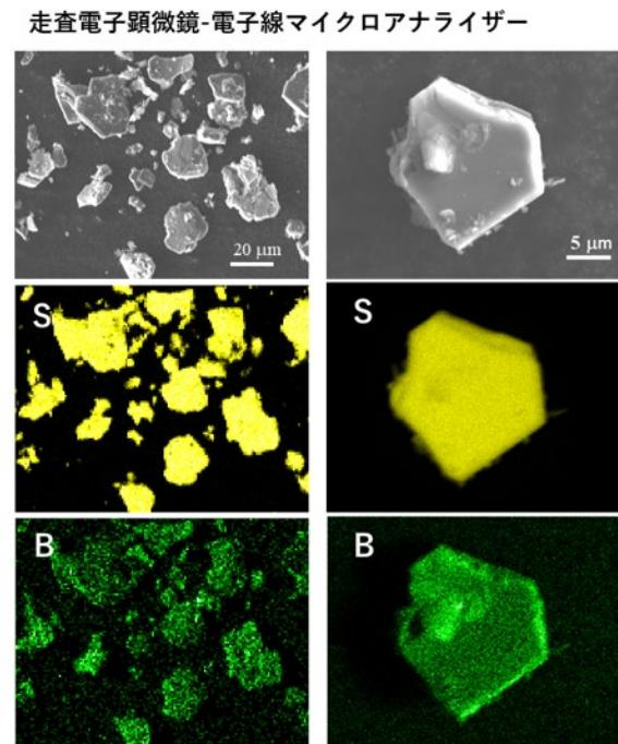
図1 菱面体硫化ホウ素の走査電子顕微鏡（上段）および電子線マイクロアナライザー観察（中段・下段）の結果。黄色は硫黄、緑はホウ素の部分を示す。両者が電子顕微鏡像と同じ形をしていることから、観察している試料が全て硫黄とホウ素で構成されていることが分かる。
