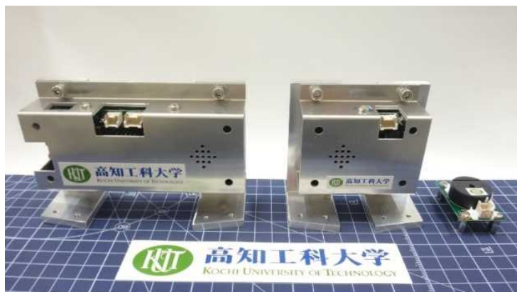
搭載するインフラサウンド計測機器 左から、メインマイク、サブマイク、ブザー
