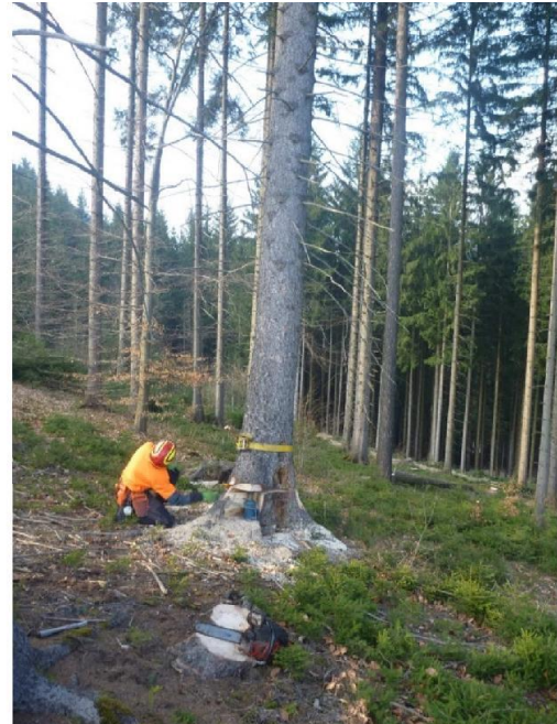
②ジャッキをつかった伐倒実習状況2 ジャッキアップで木を倒す
