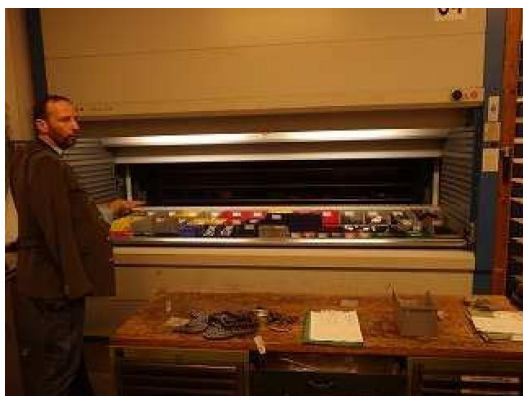
③パーツラック 自動で必要なパーツが入ったラックが選択される
