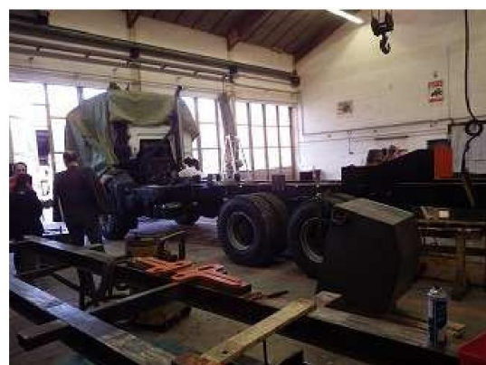
④ベースのトラックシャーシ MAN(ドイツのトラックメーカー)のもの
