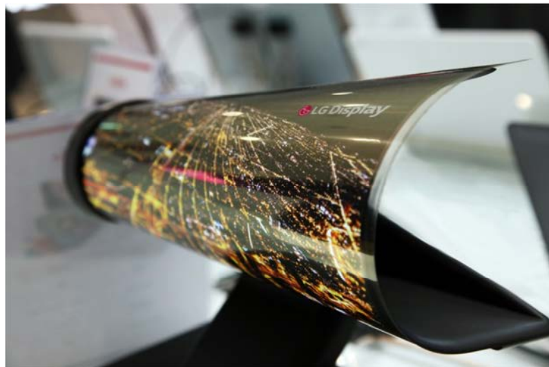
図 1.11 2016 年の CES (Consumer Electronics Show) で LG Display が展示したフレキシブル OLED ディスプレイ
