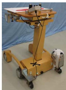
15.0kg 荷重-左前に 重心位置( d = 0.164\text{m} , \alpha = 74^\circ )
