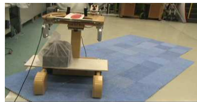
(a) 摩擦力 \approx 46\text{N} ,荷重=0kg,重心位置 (d = 0.10\text{m}, \alpha = \pi/2 \text{ rad}) (b) 摩擦力 \approx 173\text{N} ,荷重=43kg,重心位置 (d = 0.08\text{m}, \alpha = 2\pi/3 \text{ rad})
