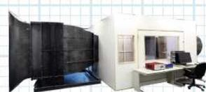
一様で乱れの少ない流れをつくる装置です。流れの中に航空機や翼などの模型を置いて空気力学的な特性を求めます。
