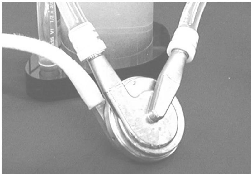
Fig. 1-2 Implant blood pump<sup>(1)</sup>
