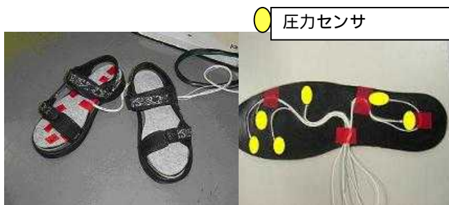
図2 足底圧推定装置
