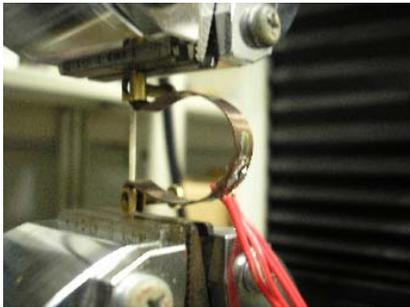
図 1 クリップゲージ（試験片装着時）
