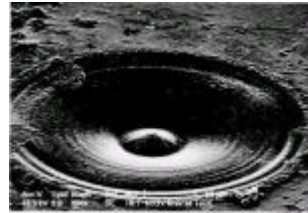
図3 各種形状の電極で加工した穴の SEM 写真
