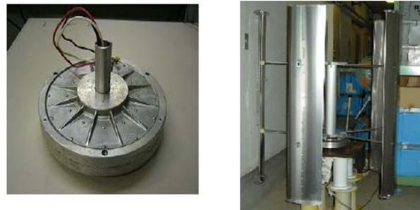
図3 低アウトローター式発電機(左) ジャイロミル型風車と発電機の組み立て(右)
