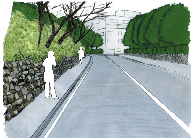
- 西側歩道 2 - 斜面を削り石垣を設け、新たな歩道をつくる。両側歩道とすることで、より安全に遊歩してもらう。
