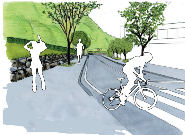
- 西側歩道 1 - 両側に歩道がなかった場所に新たに歩道をつくる。植栽を取り除き、斜面を少し削り石垣を設けた。樹木はそのまま利用する。
