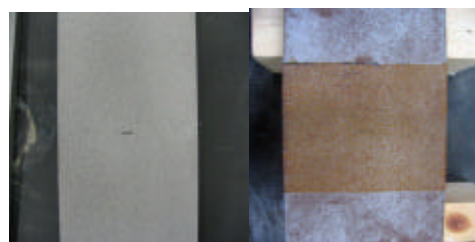
写真-4 {左・腐食前} {右・腐食後}
