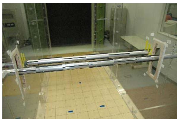
写真4. Pitch=4.5D Phase=0° 間隔3D でワイヤを平行に設置
