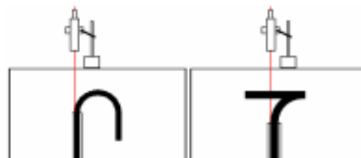
図 2: 拔出し量の測定方法
