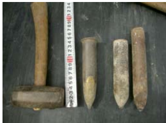
写真-3 「はつり仕上げ」に使用した道具
