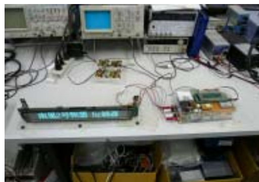
写真:4-2. VFD 駆動時の様子
