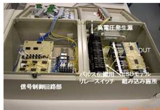
図2. 試作したESD試験装置(内側)
