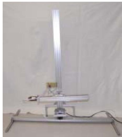
図3 製作した倒立振子
