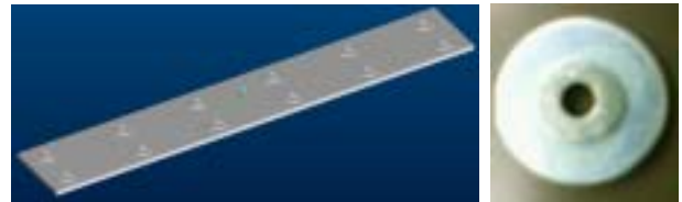
<図4> 設計したモデル (全体図/左、突起の形状/右)
