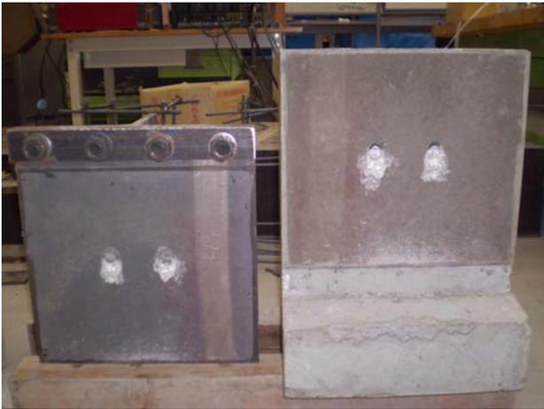
図-7 試験体No7 スタッド2本破断
