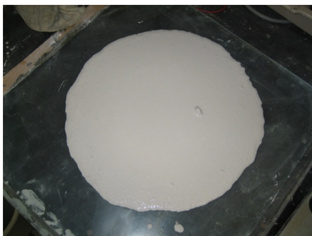
写真-1 材料分離が生じているフレッシュモルタル
